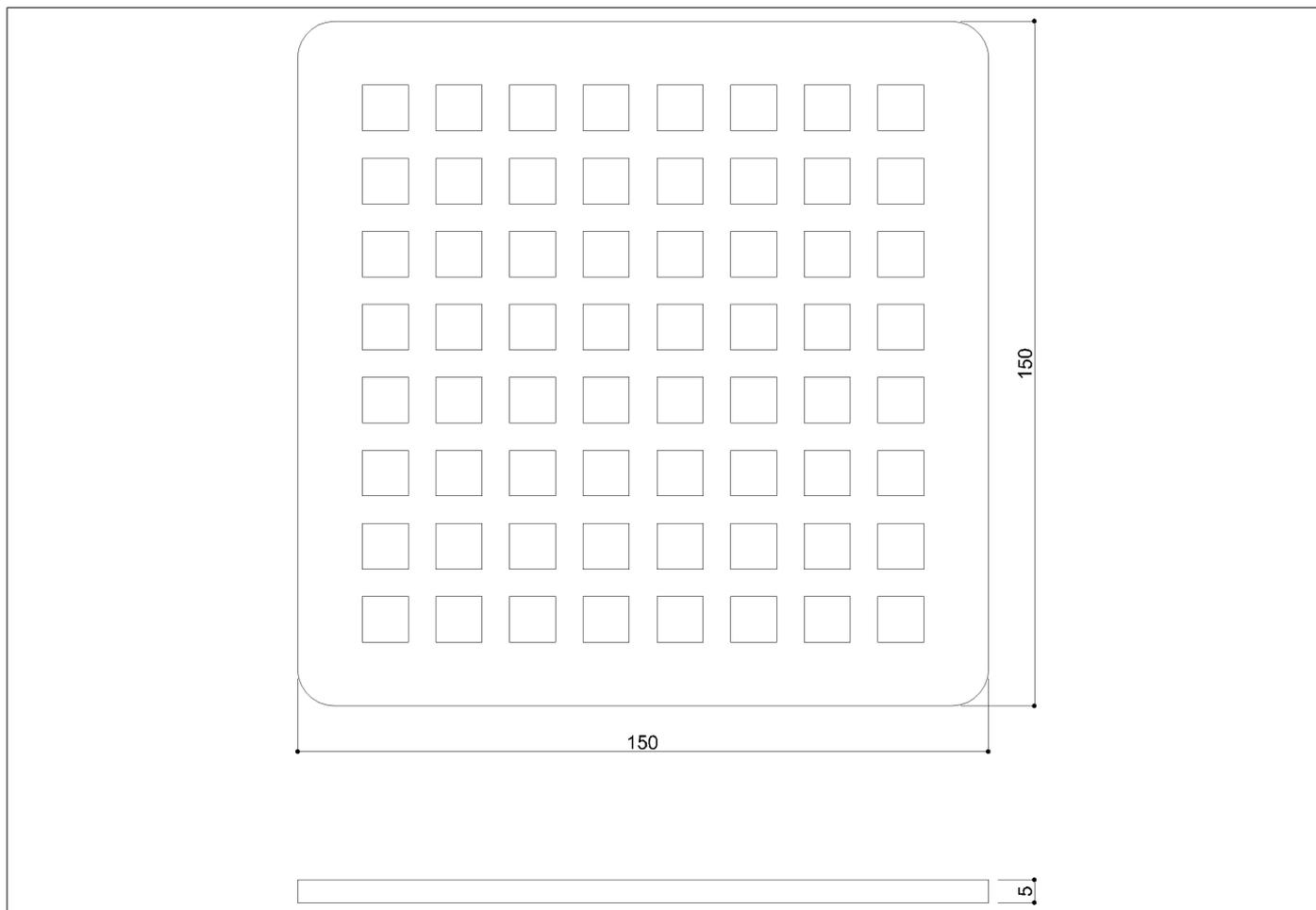
Griglia inox per sistema di scarico a scomparsa in acciaio inox
