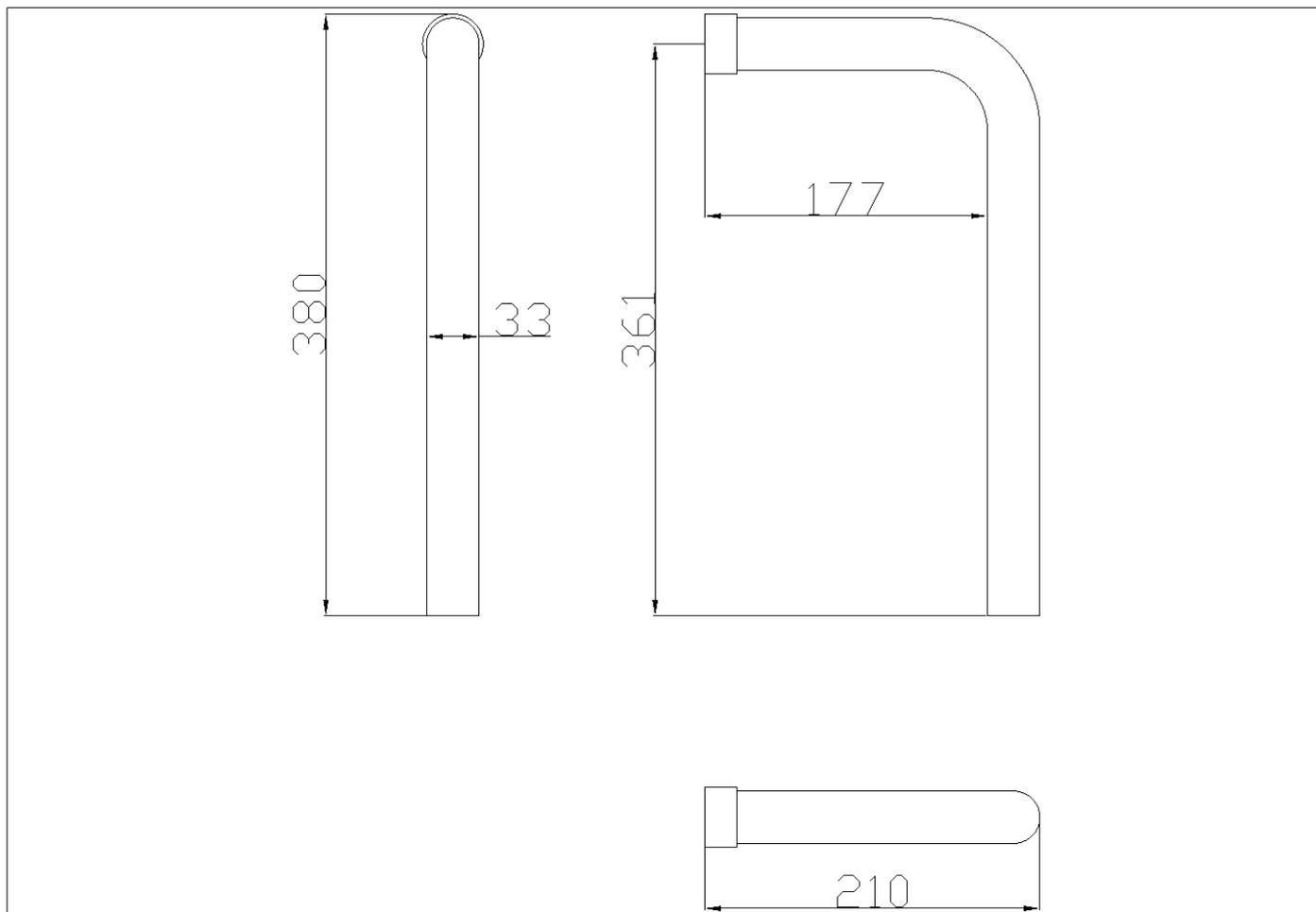
Coppia di gambe realizzata con tubo di acciaio zincato senza saldatura rivestito con vinile biocompatibile e caldo al tatto
