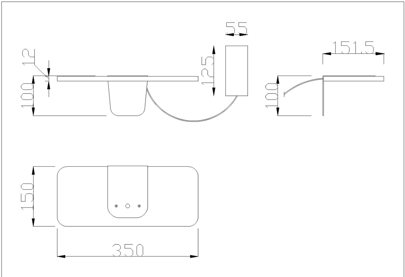
Lampada per specchio con corpo in pietra acrilica. Sistema illuminante, protetto con un diffusore in lexan, con banda a led. Munita di staffa di ancoraggio in acciaio verniciato.
