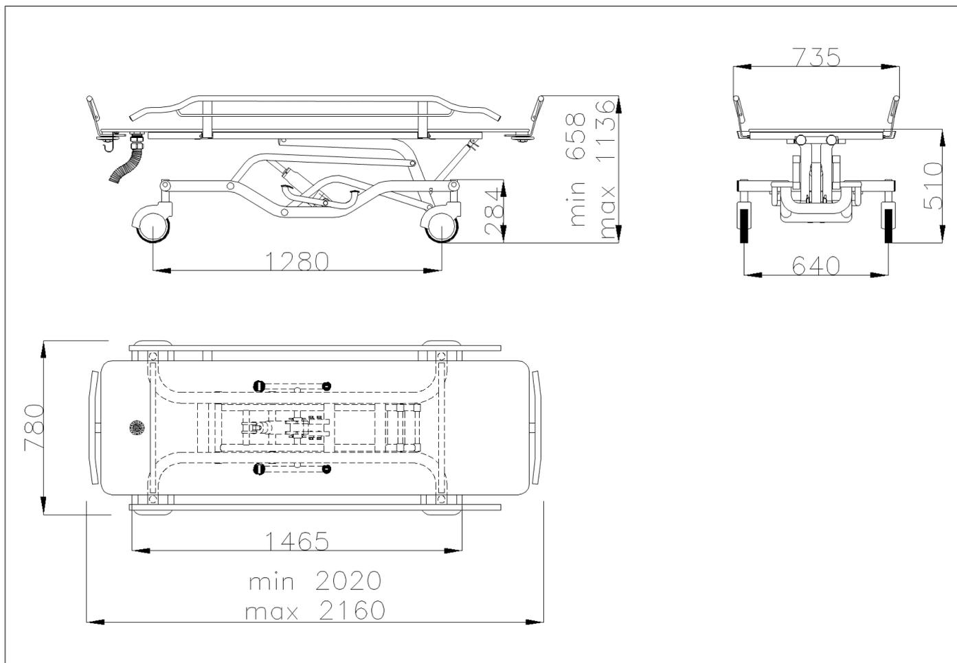
Barella doccia con altezza ed inclinazione variabili idraulicamente completa di materassino, sponde di sicurezza e tubo di scarico flessibile
