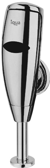
Rubinetto elettronico esterno per orinatoio U40 touch-free, con duplice sensore infrarosso, valvola solenoide, risciacquo igienico 12 ore, batteria 6V litio con durata fino a 4 anni.
