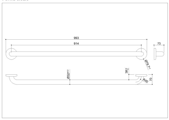
Maniglione di sicurezza, realizzato con tubo di acciaio inox AISI 304, senza saldatura, con finiture satinate
