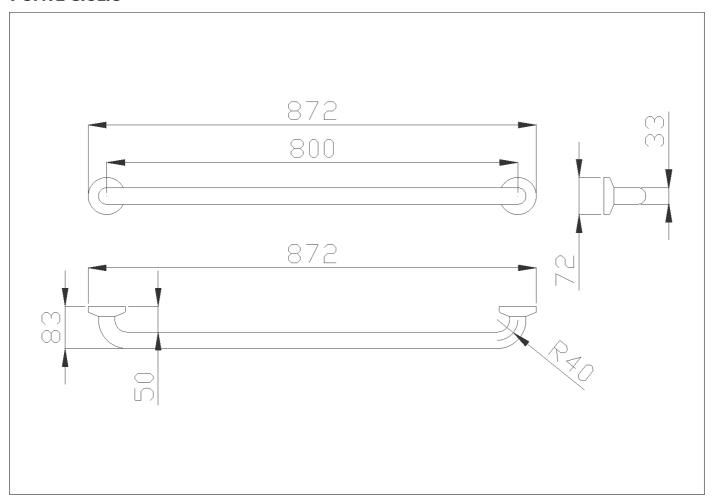
Maniglione di sicurezza, realizzato con tubo di acciaio zincato senza saldatura rivestito con vinile biocompatibile e caldo al tatto
