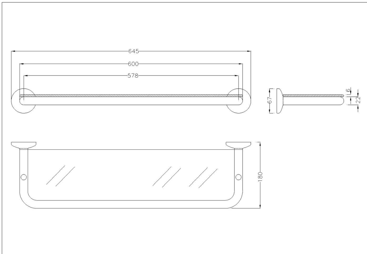
Ripiano in plexiglass con struttura realizzata con tubo di acciaio zincato senza saldatura, rivestito con vinile biocompatibile e caldo al tatto
