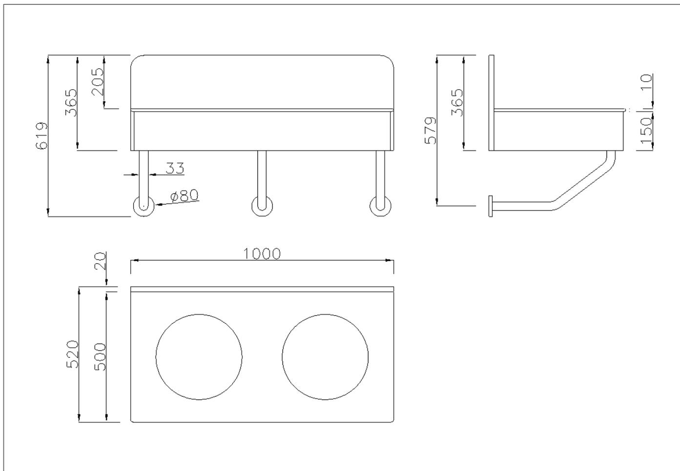
Modulo sanitario lavabo ispezionabile, per 2 lavabo. in laminato stratificato senza decoro. Munito di paraspigolo morbido.
